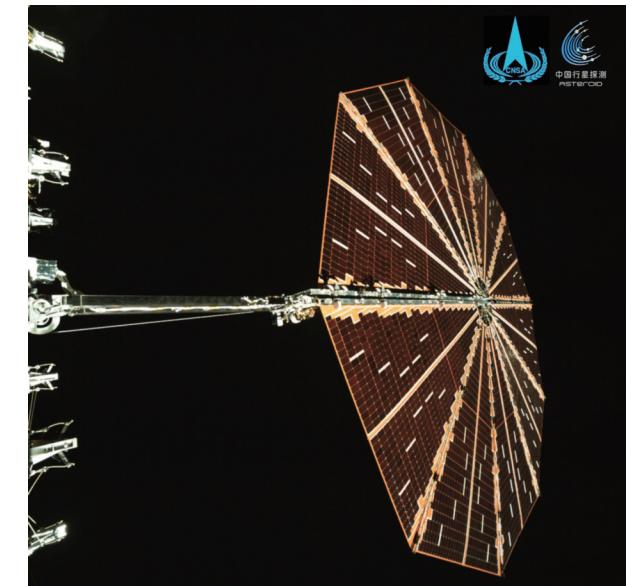
6月6日，国家航天局发布天问二号探测器传回的圆形太阳翼展开的图片。为满足在距离太阳约3.75亿千米的主带彗星开展探测的供电需求，天问二号探测器研发配置了圆形柔性太阳翼。
