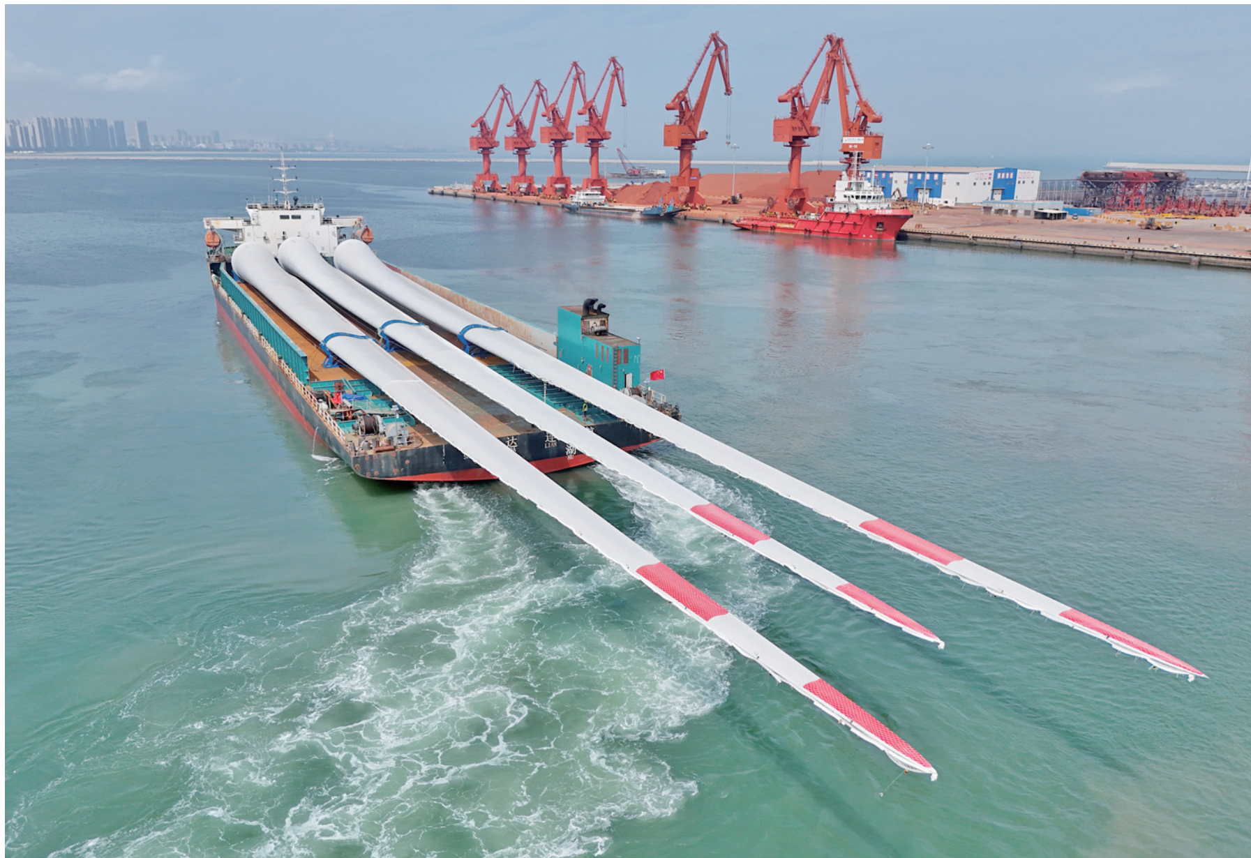
8月1日,三支超大尺寸海上风力发电机试验叶片在山东港口烟台港蓬莱港区完成装船并运往试验基地。该型叶片长达153米,重83.5吨,属于150米级超大尺寸海上风电叶片,现已完成全部静力测试,即将在试验基地进行疲劳测试验证。
