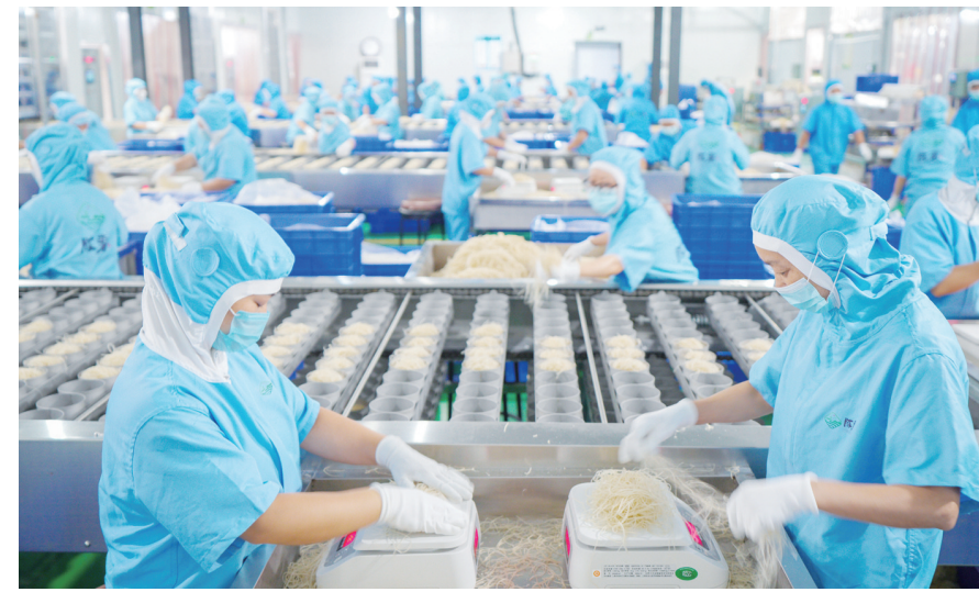
思南经开区贵州佳里佳食品有限公司生产车间,工人们正将切好的红薯粉丝称重、装碗。
