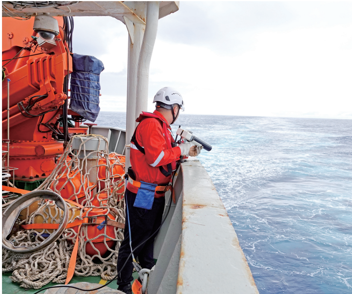
船时1月16日,“雪龙”号大洋队队员手持发射器,向海中投放抛弃式温深仪。 新华社记者 顾天成 摄
