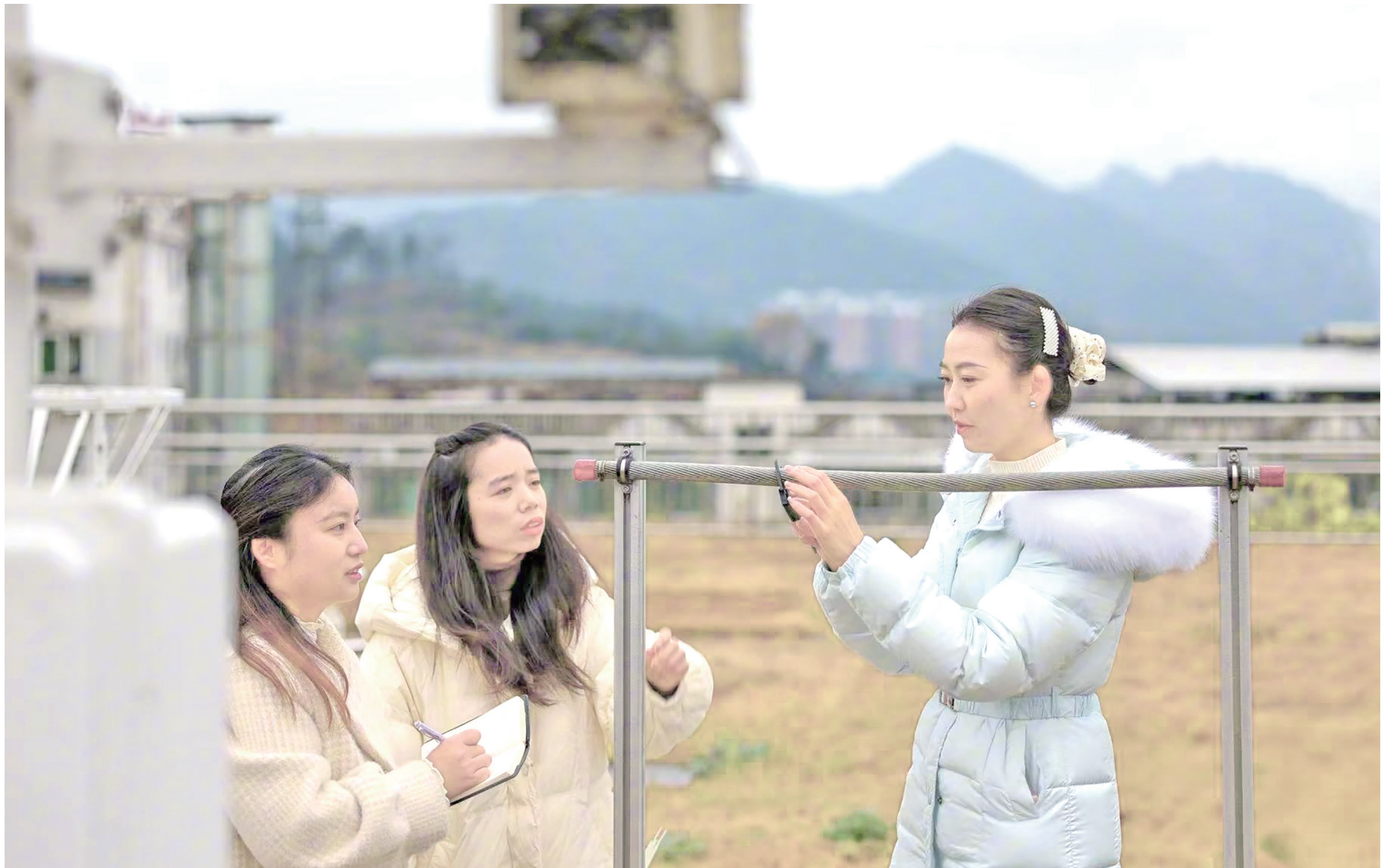
1月20日,玉屏侗族自治县气象局积极应对低温凝冻天气,实时通过短信、微信公众号、微博、应急广播等多渠道预报低温凝冻天气情况,为当地相关部门提供应对极端天气决策服务依据,保障人民生命财产安全。据悉,1月19日,玉屏侗族自治县启动低温雨雪凝冻灾害Ⅳ级应急响应。图为气象局工作人员在观测视频智能天气现象仪电线积冰厚度。胡攀学摄
