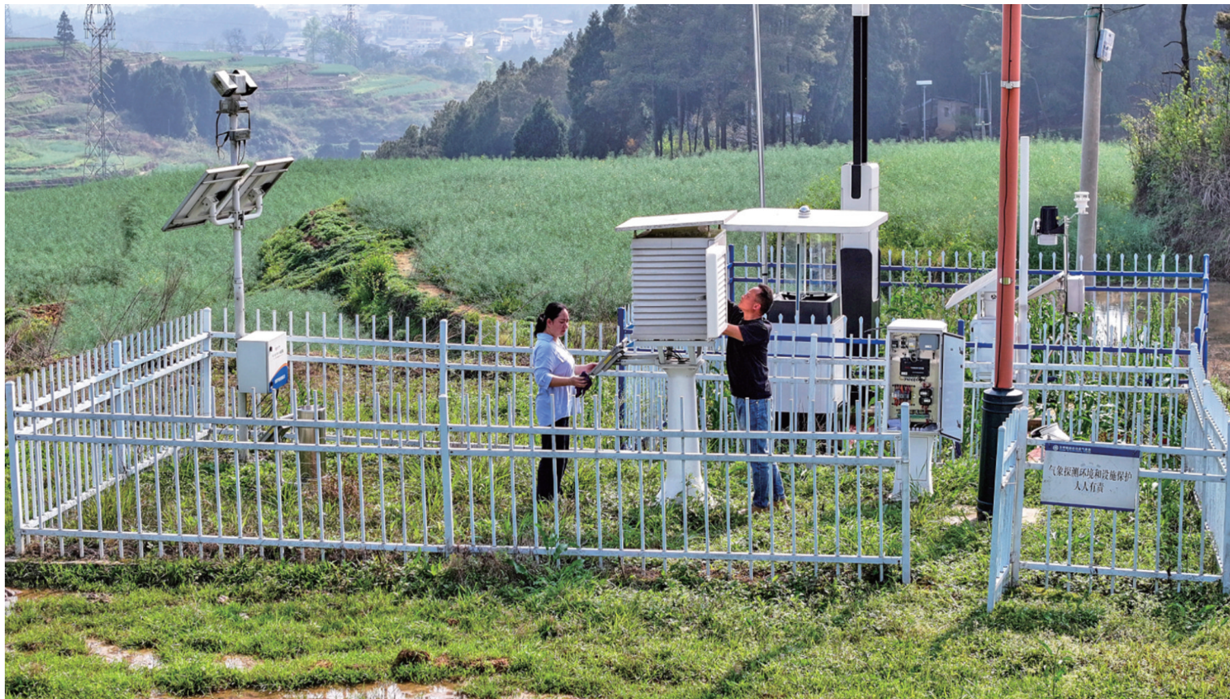
4月8日,在五屏侗族自治县鱼乡郭家村,当地气象局技术人员抢抓晴好天气,对高标准农田气象观测站进行全面检查维护,为春耕生产提供科学保障。近年来,五屏在推进乡村全面振兴工作中,不断加大农业气象观测基础设施建设力度,安装监控探头、雨量传感器、土壤检测、温度和湿度传感器等设备,为农业增产增收提供科学保障。据悉,截至3月,已建成气象观测站点31个。 胡攀学 摄
